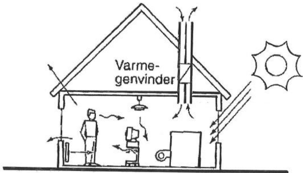
Figur 1. Ud over varmeanlægget bidrager også andre varmekilder til varmeafgivelse. På tegningen er vist både ind- og udgående varmepile.
